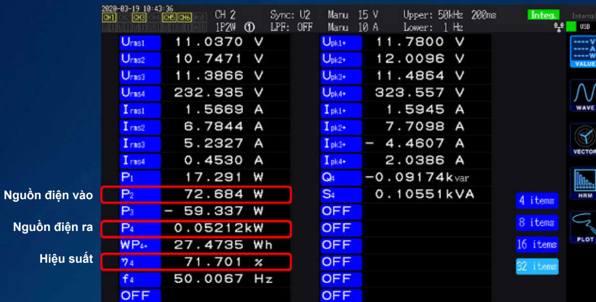
Hình 11.0 Công Suất Điện Vào, Công Suất Điện Ra Và Hiệu Suất Bộ Biến Tần
